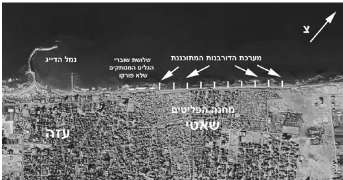
איור 7: מערכת הדורבנות המוצעת על ידי אונר"א, להגנת חוף מחנה הפליטים שאטי (תצ"א 1999).
